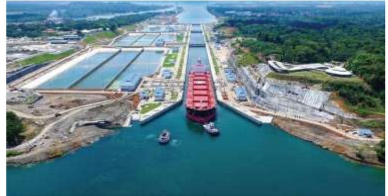
Nel momento in cui una nave si muove in acque limitate (basso fondale, canali) si avrà un restringimento della sezione di passaggio dell'acqua con conseguente aumento della velocità del fluido. Per il teorema di Bernoulli (o effetto Venturi), si avrà una riduzione di pressione e quindi una riduzione della spinta idrostatica con conseguente aumento dell'immersione (Sinkage) e variazione d'assetto (Trim). Tale effetto è denominato squat.
