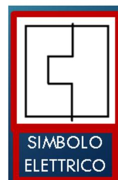
La deformazione è resa possibile dall'accoppiamento di due metalli che possiedono un coefficiente di dilatazione termica diverso, agendo su di un cinematismo determina lo sgancio del relè. Con lo sgancio si provoca generalmente la commutazione di due contatti ausiliari di cui uno utilizzato per la diseccitazione della bobina del contattore che alimenta il circuito del motore e l'altro per una eventuale segnalazione.
