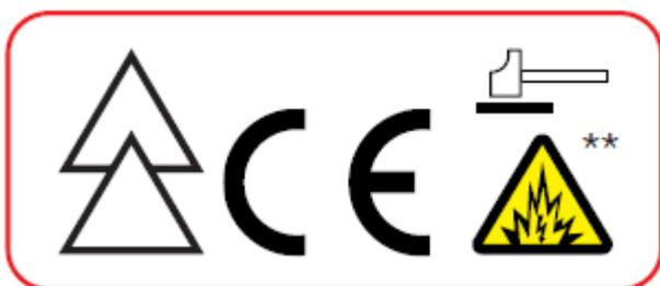
\*\* Testati per arco elettrico IEC 61482-1-2 in classe 2
