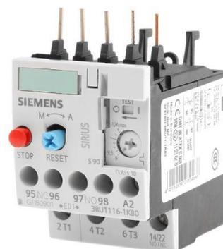
Costruttivamente si presenta costituito da un certo numero di lamine bimetalliche, una per fase, che si deformano col calore generato da un assorbimento eccessivo di corrente che permane nel circuito per un certo tempo.
