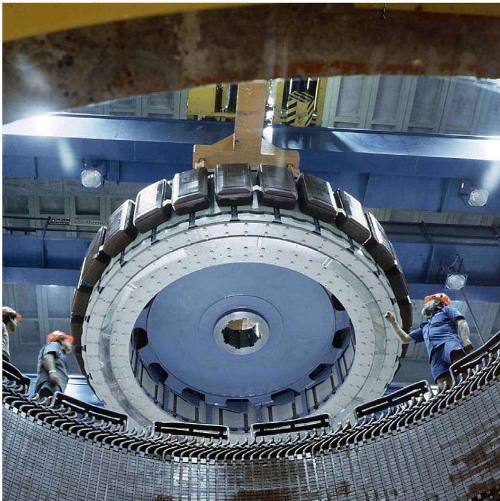
Fig. 4.2: Esempio di un rotore a poli salienti di un alternatore con 12 coppie polari
